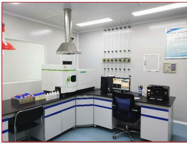
等离子体发射光谱仪 Optima 8000, 美国PE
